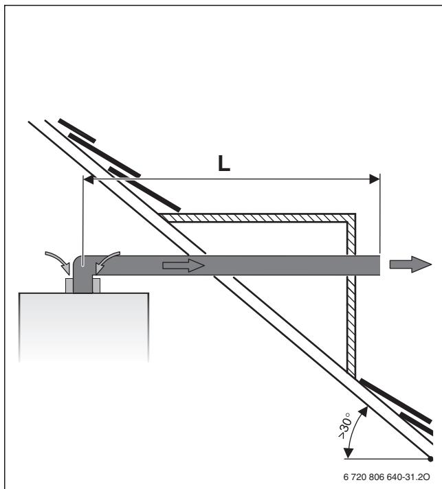
Рис. 6 Горизонтальный отвод дымовых газов B<sub>22</sub>
