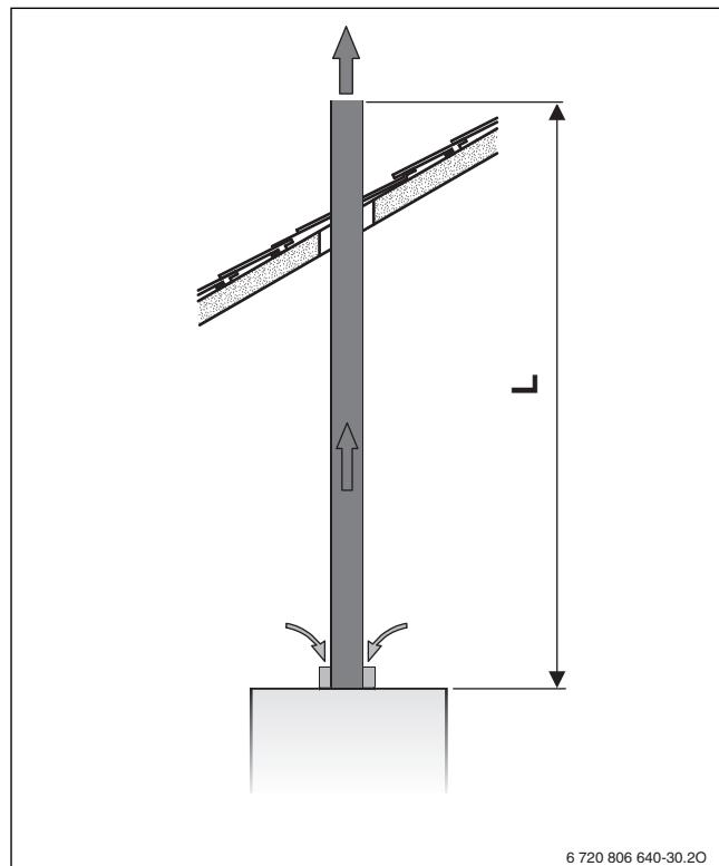
Рис. 7 Вертикальный отвод дымовых газов B<sub>22</sub>
