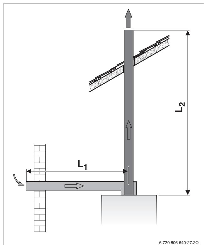
Рис. 12 Вертикальный отвод дымовых газов через отдельную трубу C<sub>52</sub>
