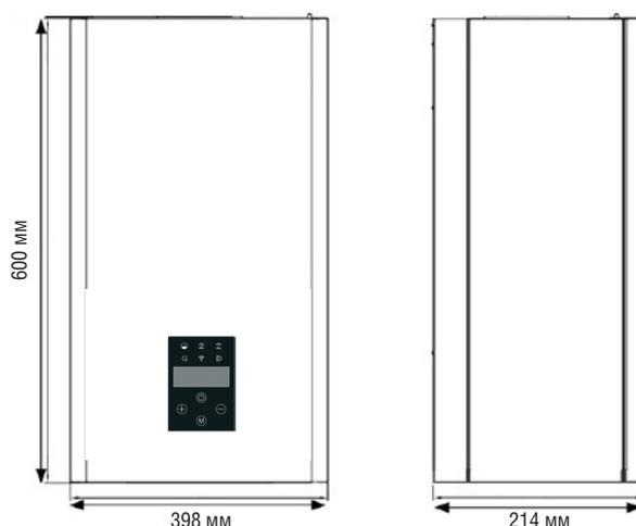
1. Повесьте котел вертикально на крепежные винты так, чтобы впускной и выпускной патрубки были снизу, соблюдая зазоры от стен и потолка, мин. 300 мм.
